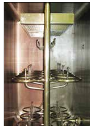
Abbildung 24: Rouging-Effekt an einer Waschmaschine in der Pharmaindustrie; vor und nach der elektrochemischen Reinigung
