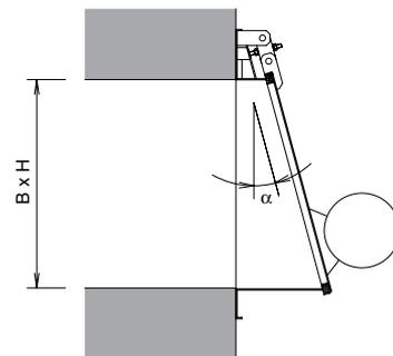
**Ausführungsform 3** Deckel als Gummilaschenklappe
