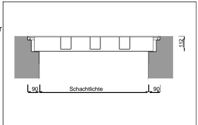
**Grundrahmen** aus gekantetem Blech mit angeschweißten Mauerankern zum Einbetonieren, mit einer umlaufend eingelegten Gummidichtung, auswechselbar.
